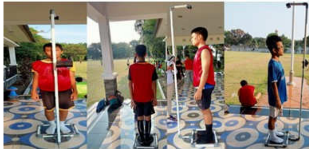
Gambar 2. Rancangan Alat Tes dan Pengukuran Tinggi dan Berat Badan Berbasis Android
