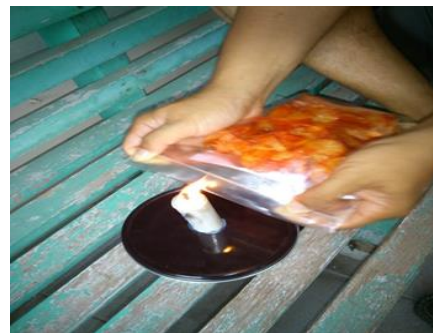
Gambar 2. Proses Pengemasan Serundeng Dengan Menggunakan Lilin
