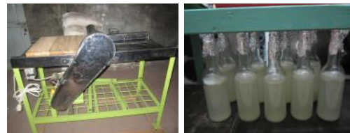
Gambar 9. Mesin Nata Gambar 10. Starter Mesin pemotong nata de soya efektif dan efisien, mampu memotong nata dalam jumlah 6kg/30 menit, sehingga dihasilkan potongan dadu dan bibit nata, hasil produk dapat dilihat pada Gambar 9 dan 10.
