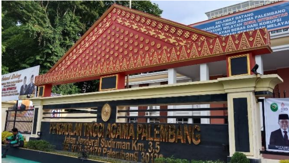
Gambar 7. Penempatan Motif Songket Palembang pada Plank Nama Pengadilan Tinggi Agama Palembang dengan Bahan Semen Menggunakan Teknik Cetak Tinggi dan Ditempel Diolah dari Sumber Pengadilan Tinggi Agama Palembang
