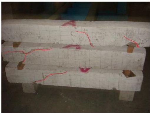
Gambar 4.2 Pola retak balok uji II
