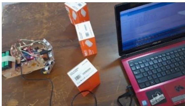
Gambar 8. Pengujian Penerapan Fuzzy Pada Robot
